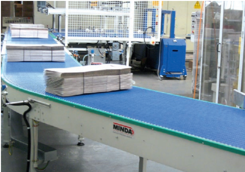
Die Förderanlage von Minda transportiert die gebündelten Päckchen – im Bildvordergrund die Quertransportlinie – zu den Palettenstapelplätzen.
