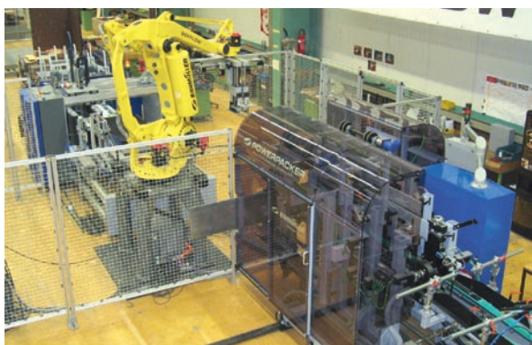
Faltschachtelklebemaschine Turbox BJD 2300 (oben) und Powerpacker (unten) vor der Auslieferung an York Container in den USA.
