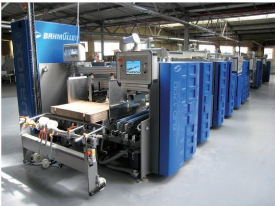
Faltschachtelklebmaschine BJD TURBOX 1700 im Klingele-Werk Grunbach
